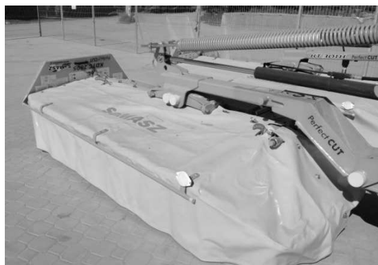
Рис. 10. Крепление брезентовой защиты на косилке
