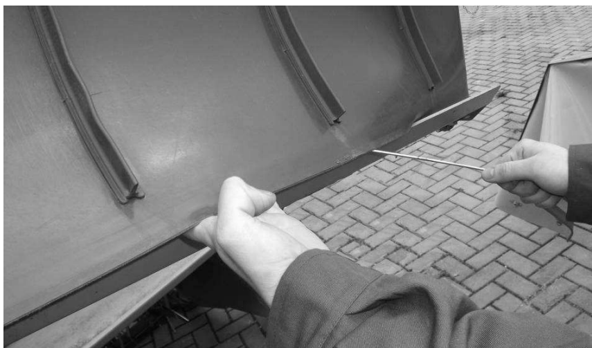
Рис. 42. Устранение загрязнений внутри ленты
