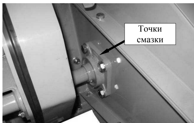
Рис. 53. Точки контроля и смазки самоустанавливающегося
