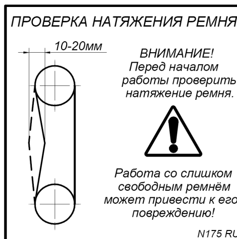
Рис. 28. Контроль и натяжение зубчатого ремня
