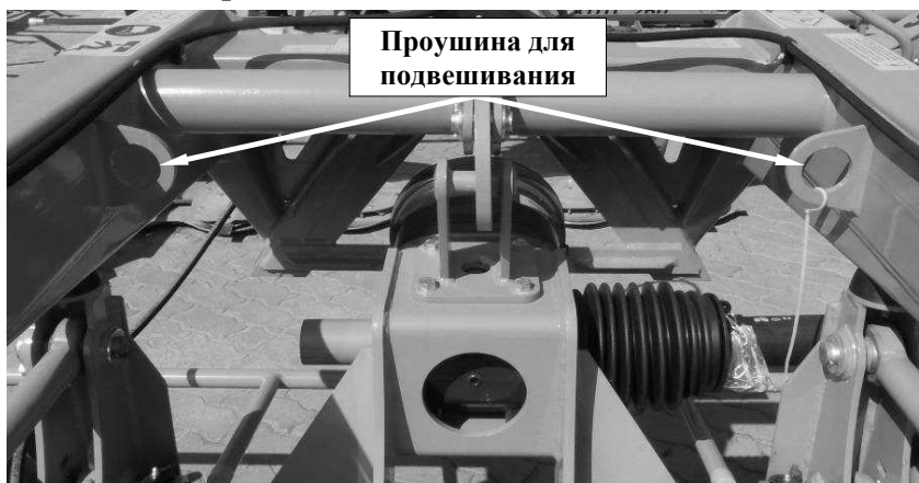
Рис. 5. Проушина для подвешивания косилки на крюк крана
