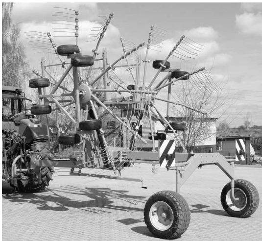
Рис. 19. Транспортная позиция (возможность изменения ширины захвата)
