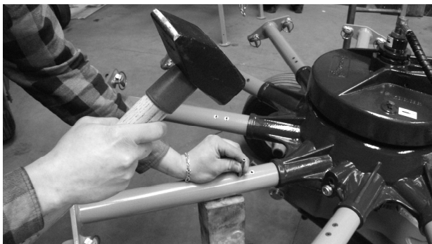
Рис. 13. Вбивание упругих штифтов
