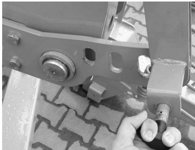
Рис. 19. Транспортная позиция (возможность изменения ширины захвата)
