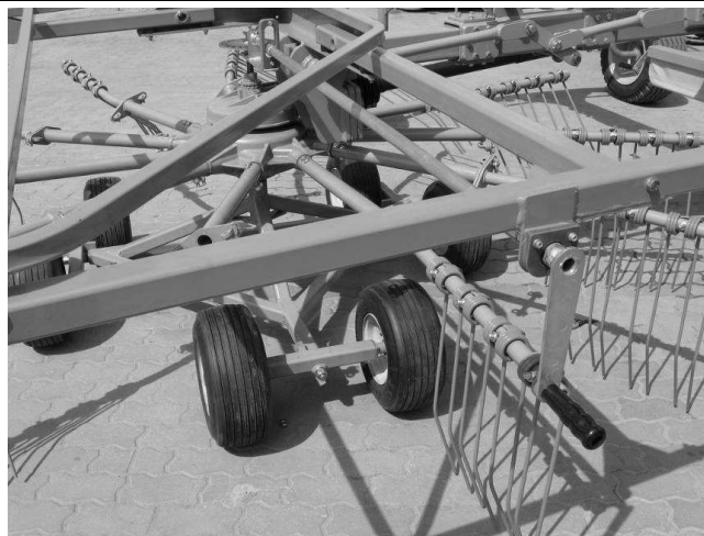
Рис. 15. Ручка регулирующая высоту сгребания
